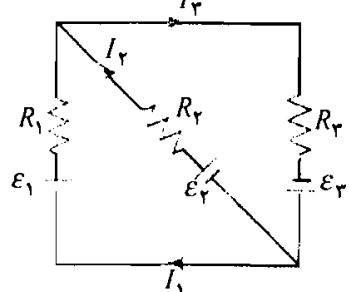
۸) در مدار شکل مقابل، جریان عبوری از هر مقاومت و اختلاف پتانسیل دو سر هر یک از آنها را به دست آورید. فرض کنید:  $\epsilon_1 = 5 \text{ V}$ ,  $\epsilon_2 = 7 \text{ V}$ ,  $\epsilon_3 = 12 \text{ V}$ ,  $R_1 = R_2 = 3 \Omega$ ,  $R_3 = 4 \Omega$
