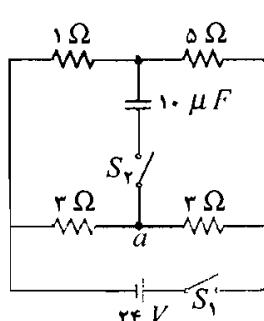
(۱۷) در مدار شکل مقابل، کلید  $S_1$  در ابتدا بسته و کلید  $S_2$  باز است. الف) اختلاف پتانسیل  $V_a - V_b$  چه قدر است؟ ب) پس از بسته شدن  $S_2$ ،  $V_a - V_b$  چه قدر می‌شود؟ ج)  $S_1$  را باز کرده و  $S_2$  را بسته نگه می‌داریم ثابت زمانی تخلیه‌ی خازن چه قدر است؟ حل:
