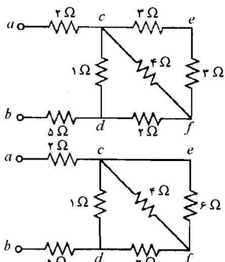
۳) الف) مقاومت معادل مجموعه مقاومت‌های شکل زیر را به دست آورید. ب) وقتی که به دو سر  $a$  و  $b$ ، اختلاف پتانسیل  $V = 10$  را وصل می‌کنیم اختلاف پتانسیل دو سر مقاومت  $\Omega = 4$  چه قدر می‌شود؟
