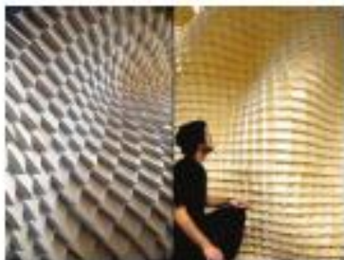
شکل ۴-۳. سطح پاسخگو به تغییرات رطوبتی با الهام از مخروط صنوبر
